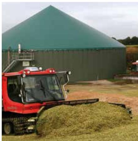
Nach der ultraexakten Siliermittel-Dosierung während des Ernteprozesses werden die kurz gehäckselten Siliergüter (5 mm theoretische Häcksellänge) in dünnen Schichten verteilt und auf  $> 240 \text{ kg Trockenmasse/m}^3$  verdichtet!
