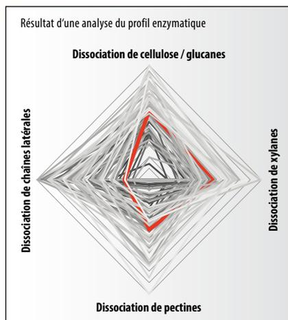
Le résultat de l'analyse du profil enzymatique permet la formulation fine du mélange BC.ZYM spécifique à l'installation.
