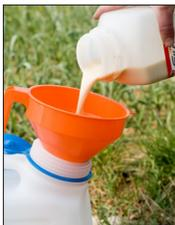
**4.** Das angemischte Bakterienkonzentrat über einen Siebtrichter in die Konzentratbehälter des Dosiergerätes umfüllen.
