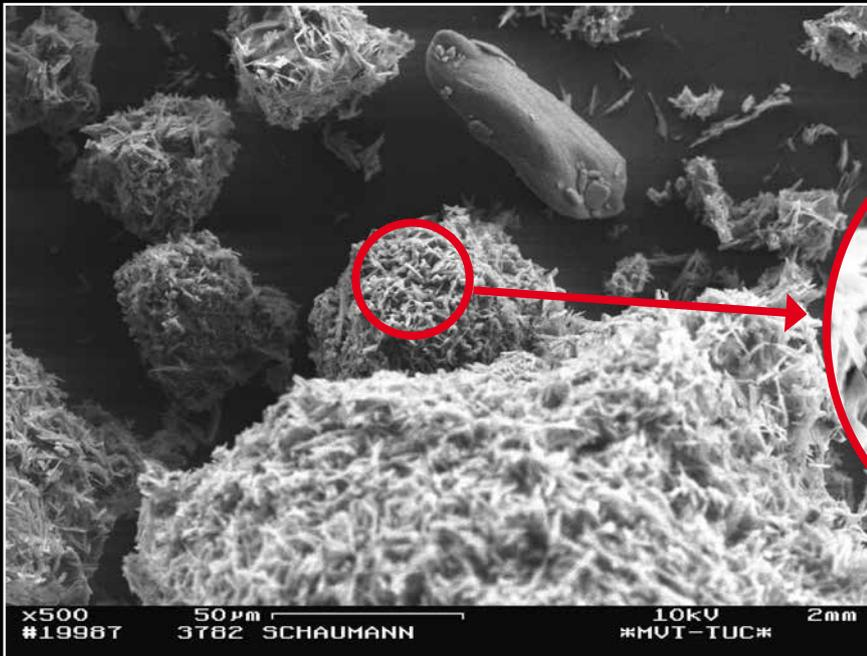
Aufnahmen mit dem Elektronenrastermikroskop von ACTILINC-Kupfer (Kupferyllat) zeigen die für den Herstellungsprozess typischen Kristallnadeln.
