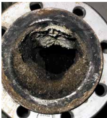
Darst. 4: Struvitausfällungen in der Gärrestauffbereitung
