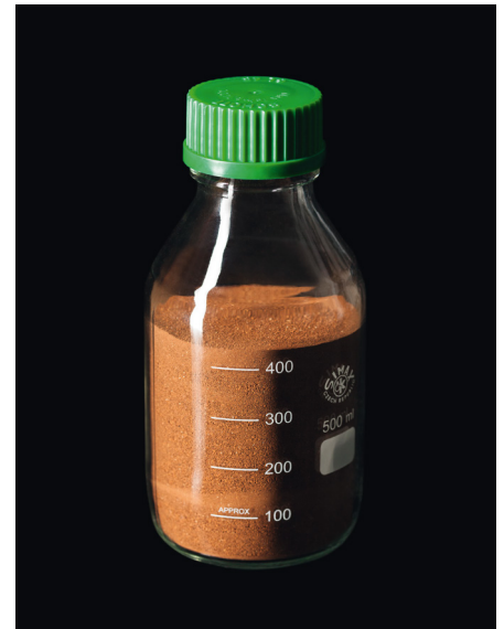
BC. ATOX Scon lie le sulfure d'hydrogène en sulfure de fer difficile à dissoudre
