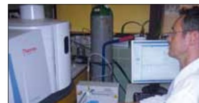
Analisi ICP per la determinazione dei microelementi
