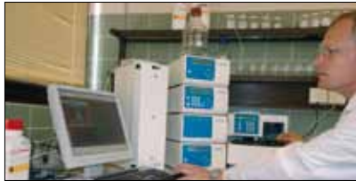
Analisi dei gas di fermentazione con tecnica HPLC
