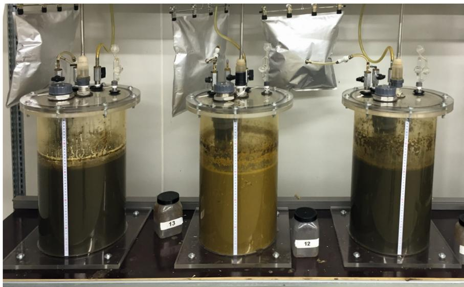
**Panta Rhei – et tout coule.** Exemple de matière première avec 90 % de fientes de volailles à 7,8 g de  $\text{NH}_4^+$  et 90 g/l d'oDM – dans des réacteurs de laboratoires d'ISF Schaumann Research
