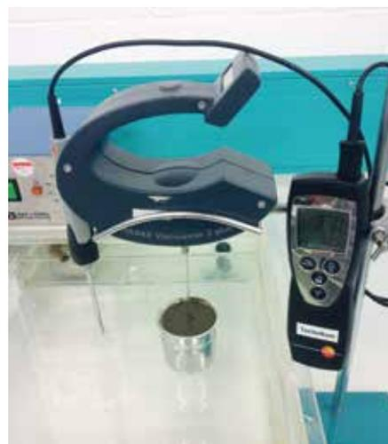
Rotationsviskosimeter - eine der im Versuch genutzten Messapparaturen
